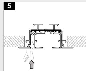
Demontage • Disassembly • Démontage
